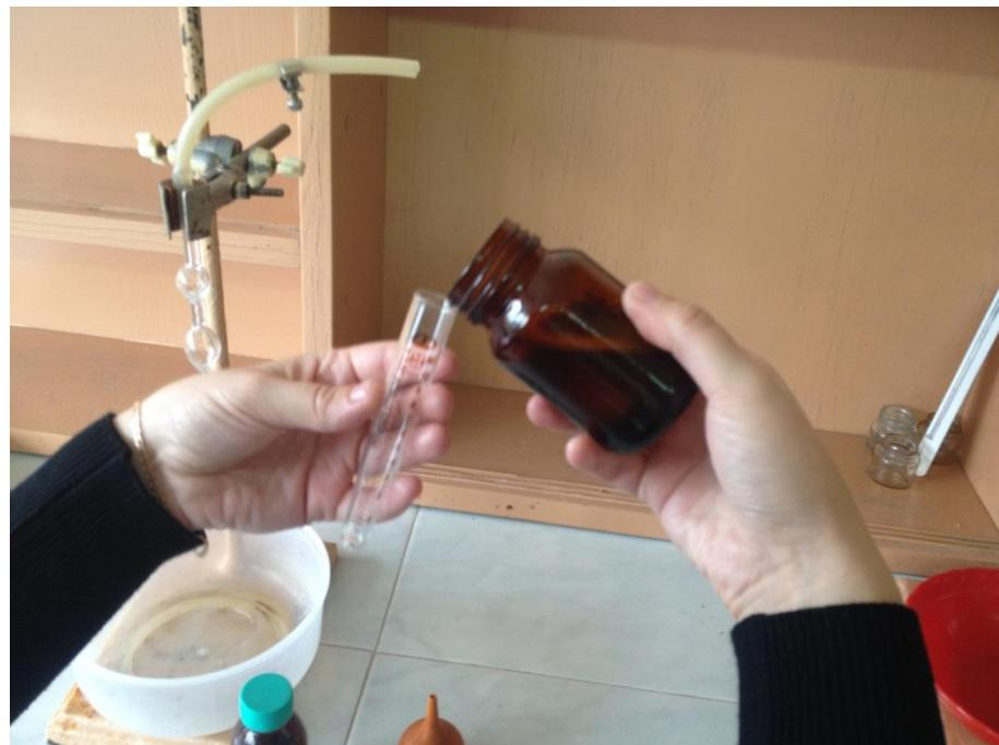
Фото 2. Отмериваем 10 мл дистиллированной воды
