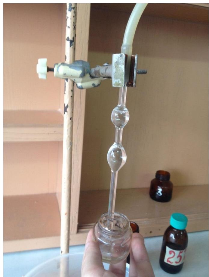
Фото 9. Набираем исследуемый раствор до конца трубки.
