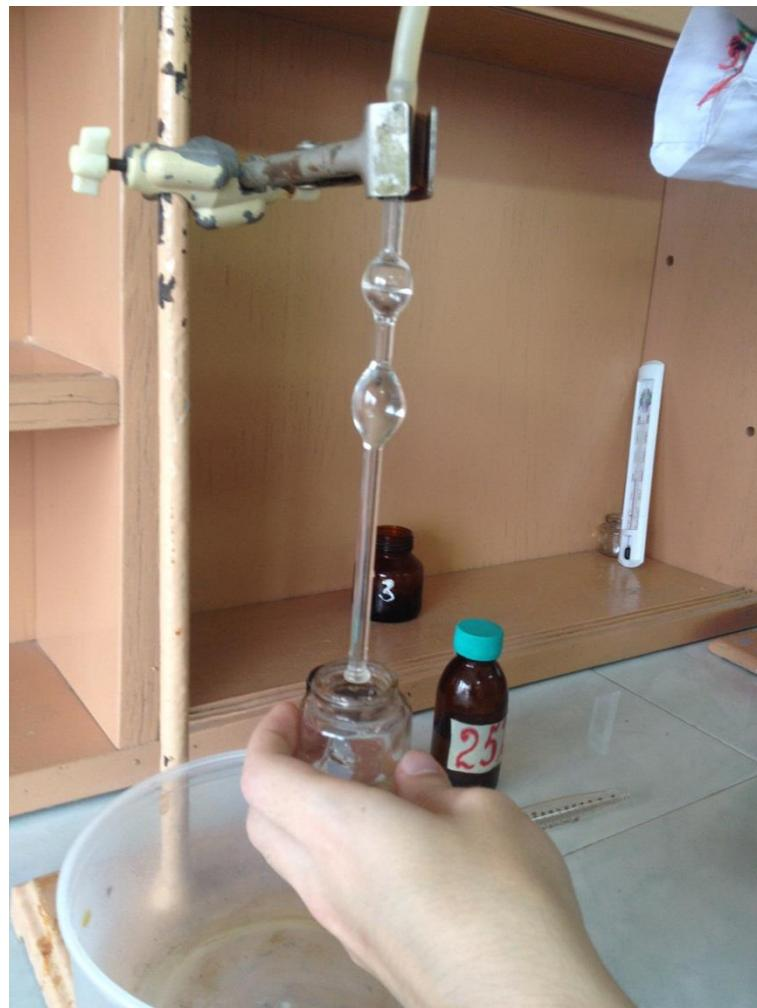
Фото 10. Спускаем жидкость до середины верхнего расширения
