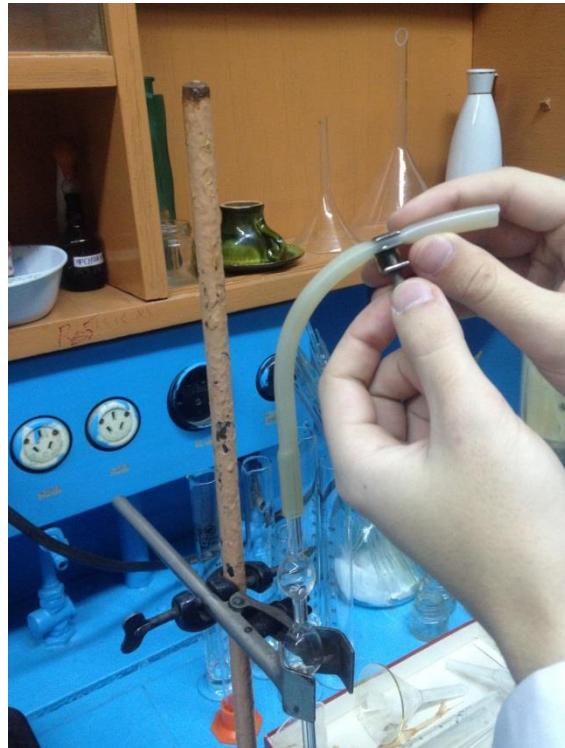
Фото 8. Закрепляем зажим так, чтобы раствор капал, а не струился.
