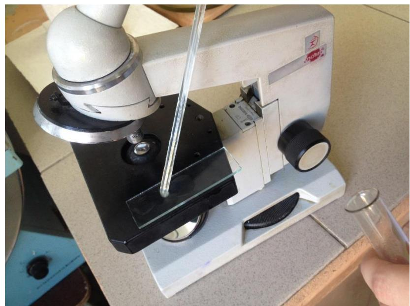
Фото 25. Каплю эмульсии полученную в опыте с желатозой стеклянной палочкой наносим на чистое предметное стекло.
