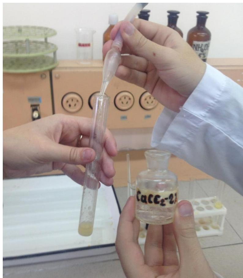
Фото 40. К оставшейся в пробирке эмульсии добавить несколько капель 2%-ного раствора  $\text{CaCl}_2$  и интенсивно встряхиваем.
