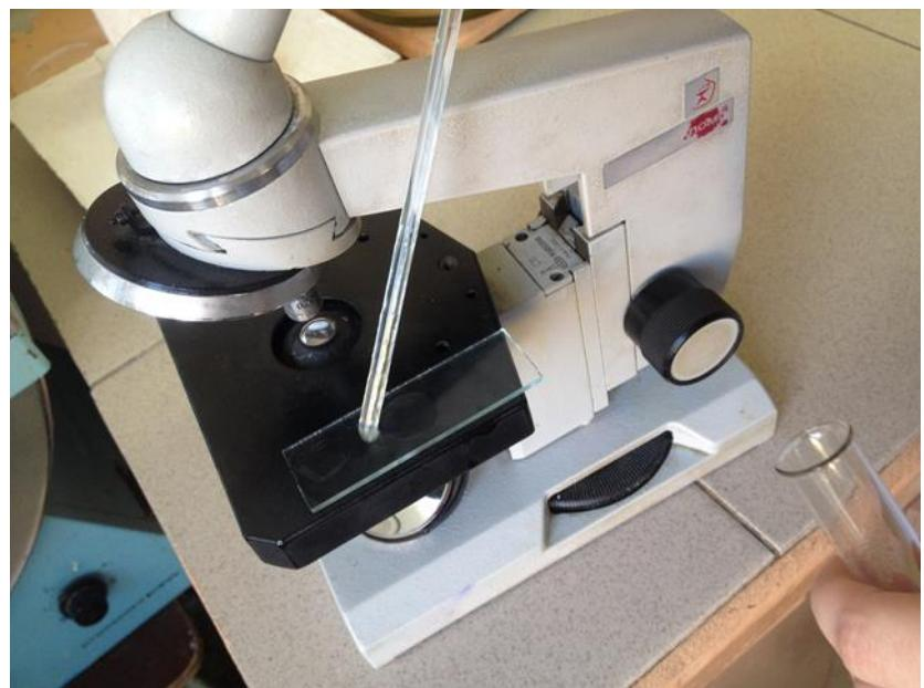
Фото 26. Рядом наносим каплю дистиллированной воды
