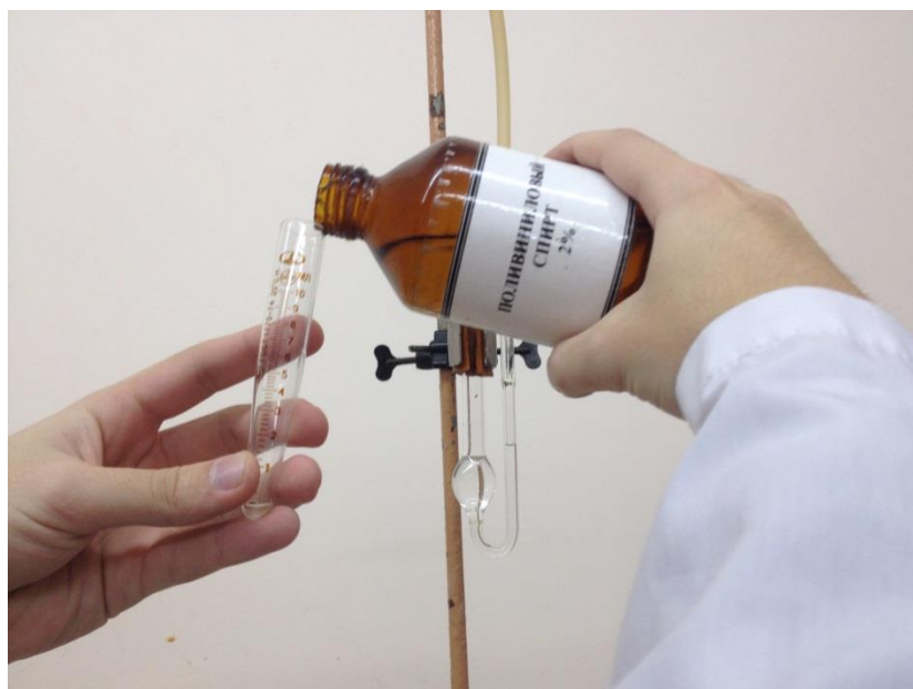
Фото 3. Отмериваем 10 мл раствора поливинилового спирта.
