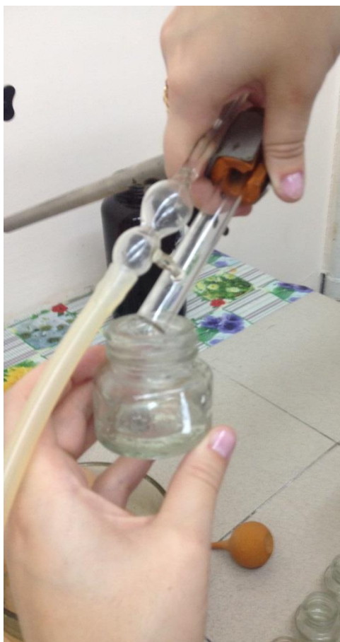
Фото 8. Воду выливаем. (Промыть вискозиметр не менее 3 раз).
